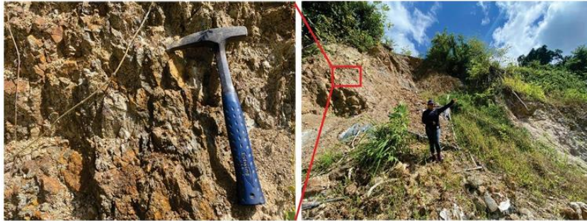
Satuan batugamping packstone LP 35 dengan azimuth foto N 93° E
